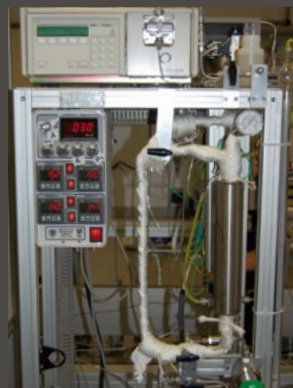
Reactor de reformado de bioetanol para la validación de los catalizadores. Bioethanol reforming reactor for the validation of catalysts.
